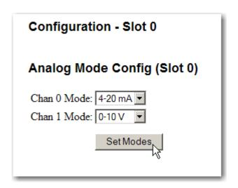
FIG. 4-76 CONFIGURATION SLOT 0/SETING MODES
