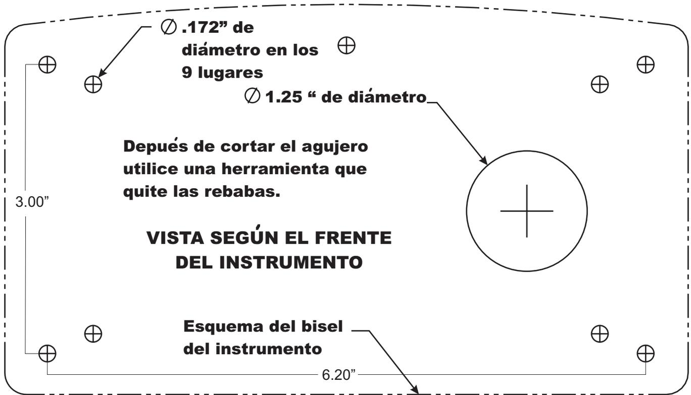
**Plantilla de recorte para el tablero de montaje serie HI 4000.
